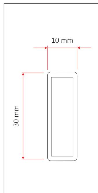
Base con tubo centrale per composizione mensola a pavimento con tubo a sezione rettangolare modello **QT**.
