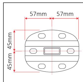
Base con tubo decentrato per composizione mensola a pavimento con tubo a sezione rettangolare modello **QT**.
