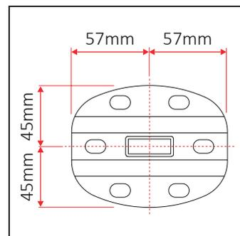
Основание с децентрализованной трубой для композиции напольного кронштейна с прямоугольной трубкой модель **QT**.
