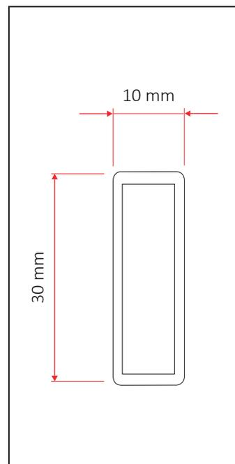
Основание с центральной трубой для композиции напольного кронштейна с прямоугольной трубкой модель **QT**.
