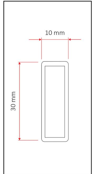
Base con tubo centrale per composizione mensola a pavimento con tubo a sezione rettangolare modello **QT**.
